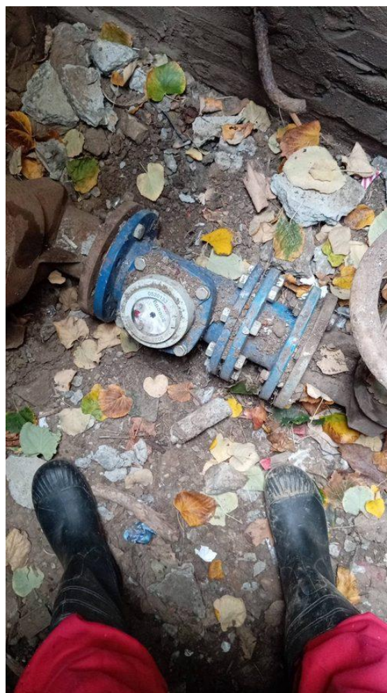
Slika 3. Mehanički vodomerni DN50 u podrumu stambene zgrade i stari mehanički vodomerni izvađen iz tla, sa vidljivim habanjem.
